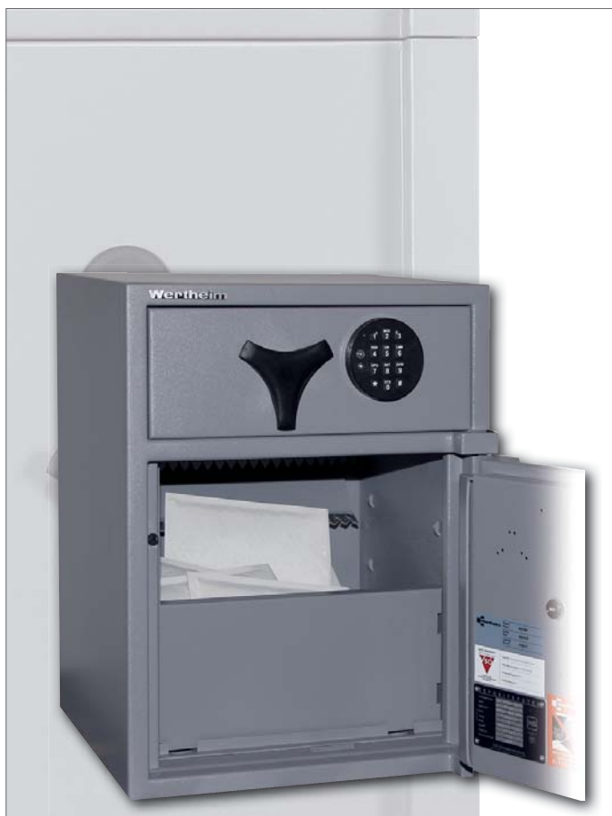
Abb. Deposit-Wertschutzschrank AG15DF - Lade vorne, K-Schloss Cawi 2 Schlüssell (95 mm), Ladensperre: E-Schloss M-Locks EM2020 Schwenkriegel, Option: 1 Rückhalteblech
