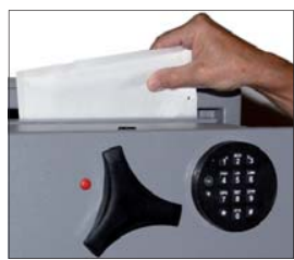
Abb. Deposit-Wertschutzschrank AG15DF - Lade vorne, K-Schloss Cawi 2 Schlüssell (95 mm), Ladensperre: E-Schloss M-Locks EM2020 Schwenkriegel, Option: 1 Rückhalteblech
